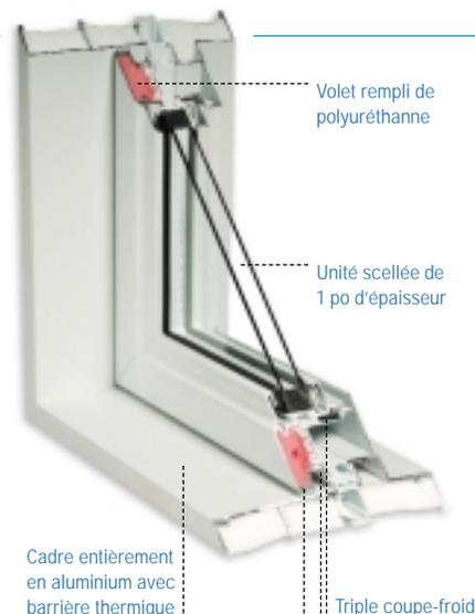
Nous utilisons des scellants extérieurs exclusifs qui offrent une protection accrue contre les infiltrations d'air et d'eau, en plus de conférer une allure très esthétique au cadre. Notre barrière thermique multichambre, entre les cadres intérieur et extérieur, renforce le tout, en plus d'accroître l'efficacité énergétique.
